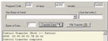
Рис. 7. LOAD_DATA: контроль изменений в регистре прерываний IBNIRQ
