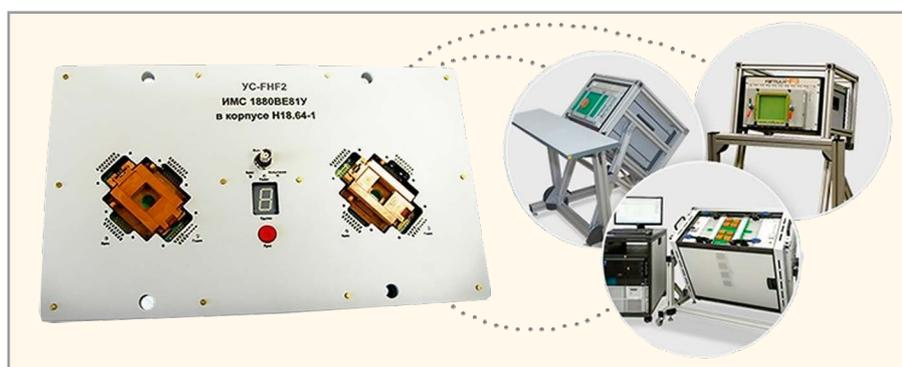
Рис. 1. Измерительная оснастка для оборудования Formula HF2
