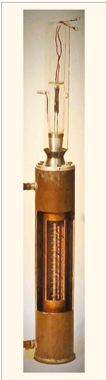
Рис. 3. Мощная радиолампа (25 кВт) с охлаждением проточной водой в разрезе. Музей НРЛ
