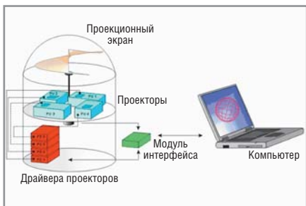
Рис. 3. Структура портативной 3D-дисплейной системы Felix
