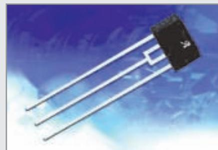
A1357 преобразует аналоговый сигнал внутреннего элемента Холла в ШИМ-кодированный выходной сигнал с несущей частотой 1 кГц. Цифровые ШИМ-выходы обладают лучшей помехоустойчивостью по сравнению с аналоговыми выходными сигналами. Датчик соответствует требованиям директивы RoHS и поставляется в трёхконтактном SIP-корпусе без содержания свинца. Выводы имеют гальваническое покрытие чистым цинком.
