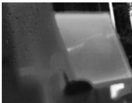
Рис. 3. Дефектные пиксели на изображении, получаемом с микроболметра
