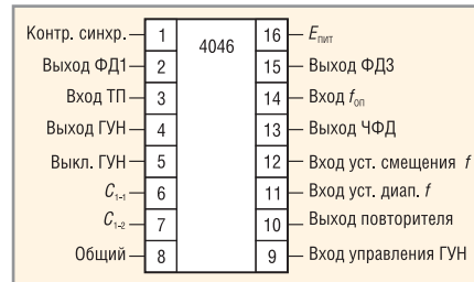
Рис. 5. Нумерация выводов микросхемы CD4046
