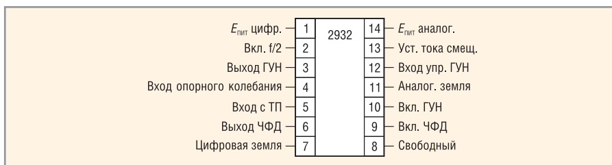
Рис. 11. Нумерация выводов микросхемы TLC2932
