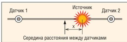
**Рис. 1. Пространственная структура трубы с источником шумового сигнала и с двумя приёмными датчиками**
