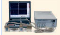
определения модуля коэффициента отражения устройств, работающих с переносом частоты.
