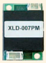
Основным отличием является расширение диапазона входных напряжений от 2,4 до 21 В, возможность питания кластеров с количеством от 2 до 11 полупроводниковых ламп XLamp™ с кристаллами AllnGaP на SiC и от 1 до 7 – с кристаллами InGaN на SiC.
