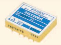
DC/DC-преобразователи способны выдерживать импульсные напряжения с амплитудой 50 В в течение 1 с. Диапазон рабочих температур –55...125°С (температура основания корпуса). Поставляются изделия с двумя уровнями отбраковки: стандартный и специальный (ES).
