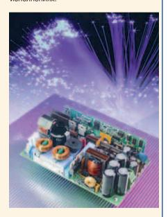
Разработанные главным образом для медицинских применений, изделия серии РВМ200 поставляются укомплектованными кожухом и встроенным вентилятором и выдают в нагрузку до 200 Вт; доступны также изделия с конвекционным отводом тепла, с выходной мощностью 100 Вт. Аналогичные модели РВМ300 характеризуются номинальной выходной мощностью 300 и 150 Вт соответственно.
