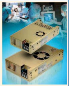
Габариты ИП серии PBM200 - 177,8  $\times$  101,6  $\times$  38,1 мм, PBM300 - 190,5  $\times$  114,3  $\times$  44,45 мм. Серия PBM200 состоит из 22 моделей, серия PBM300 включает в свой состав 21 модель. Номинальные значения выходных напряжений от 3,3 до 48 В постоянного тока, в 1-, 2-, 3- и 4-канальных исполнениях.
