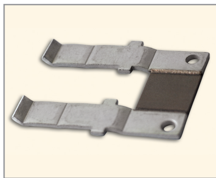
Рис. 1. Сварка разнородных материалов – меди и алюминия
