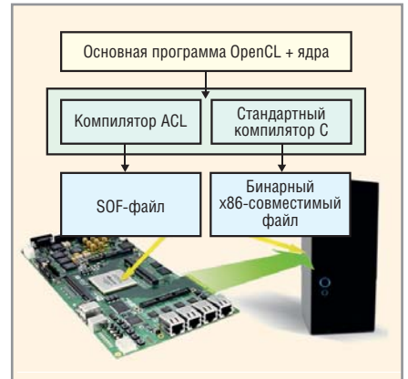
Рис. 3. Единая среда разработки на базе OpenCL-FPGA компании Altera
