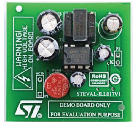
Рис. 4. Плата драйвера постоянного тока для сверхъярких светодиодов STEVAL-ILL017V1
