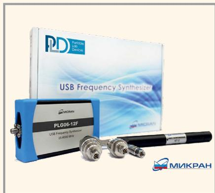
Portable Lab Generator (PLG06) – портативный сверхширокополосный синтезатор гармонических сигналов, перестраиваемых по частоте в диапазоне от 25 МГц до 6 ГГц и по мощности в диапазоне от –40 дБм до +10 дБм, с различными типами аналоговой модуляции (AM, ЧМ, ФМ, ИМ);
