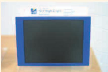
и высоким контрастом изображения (500 : 1), предназначен для применений, требующих считывания информации в условиях сильной освещённости, при небольшой потребляемой мощности, – например, в мобильной аппаратуре, где ёмкость АКБ является ограничивающим фактором.
