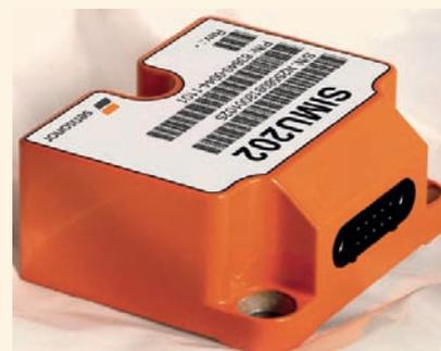
роскопов. Входной диапазон ±400°/с, выход – 24-битный цифровой сигнал, откалиброванный во всём рабочем диапазоне температур.
