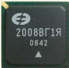
Микросхемы выполнены в виде многокристального модуля и содержат два кристалла 14-разрядных АЦП конвейерного типа с частотой оцифровки до 20 МГц и цифровой контроллер. Кристаллы изготовлены по 0,25-мкм технологии и размещены в корпусе BGA-192 размером 17 × 17 мм. Диапазон рабочих температур микросхем от -60 до +85°C.
