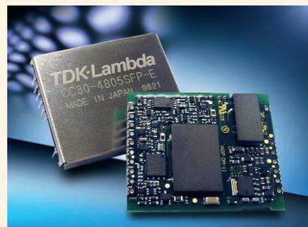
Ферритовые сердечники собственной разработки с малыми магнитными потерями гарантируют высокий КПД в очень малом объеме при небольшой высоте. Например, 30-Вт модуль CC30-4805SFP-E имеет габариты 37,9 × 31,6 × 6,5 мм, значение КПД достигает 92,5%, значение удельной мощности 63,2 Вт/дюйм<sup>3</sup> (примерно 3850 Вт/дм<sup>3</sup>).
