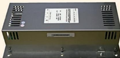
Преобразователь MHVC250 характеризуется широким диапазоном входного напряжения 420...975 В, которое преобразуется в напряжение 24 В постоянного тока для обеспечения электропитанием сигнальных ламп и станций текущего контроля электронного оборудования. Модуль MHVC250 может также применяться в качестве самостоятельно запускающегося модуля в бортовой аппаратуре трамваев или троллейбусов при разряде аккумуляторов.
