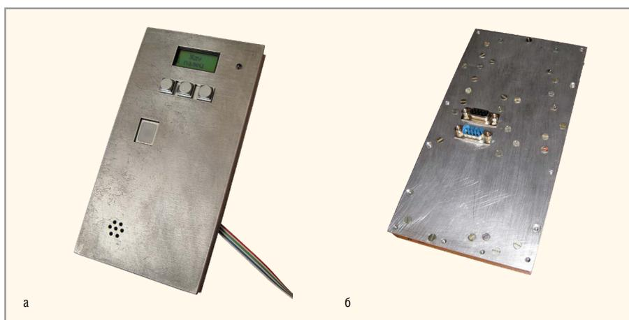
**Рис. 4. Внешний вид контроллера замка:** а – лицевая сторона; б – оборотная сторона
