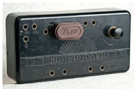
Рис. 2. Последний промышленный детекторный приёмник в СССР (1950 г.)
