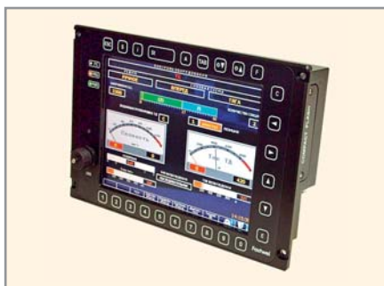
Рис. 10. Панельный компьютер BC01 (Fastwel, Россия)
