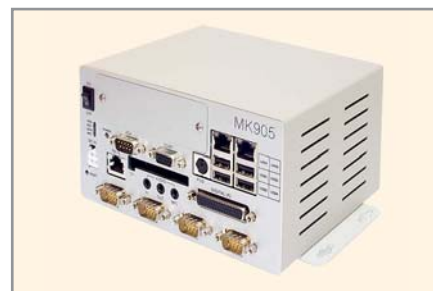
Рис. 7. Защищённый компьютер MK905 на базе процессора AMD Geode LX800 (Fastwel, Россия)
