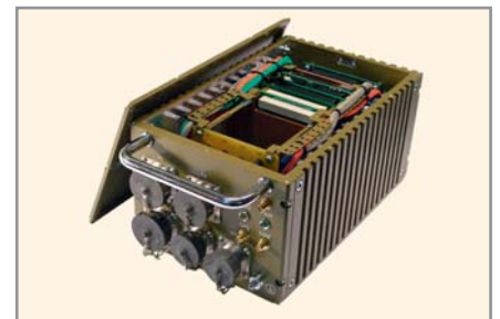
Рис. 13. Защищённый заказной компьютер МК308 (Доломант, Россия). Корпус разработан для поддержки модулей PC/104 и StackPC, в том числе с оригинальной системой кондуктивного теплоотвода
