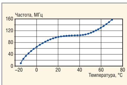
**Рис. 3. Температурно-частотная характеристика кварцевого генератора 10 МГц**
