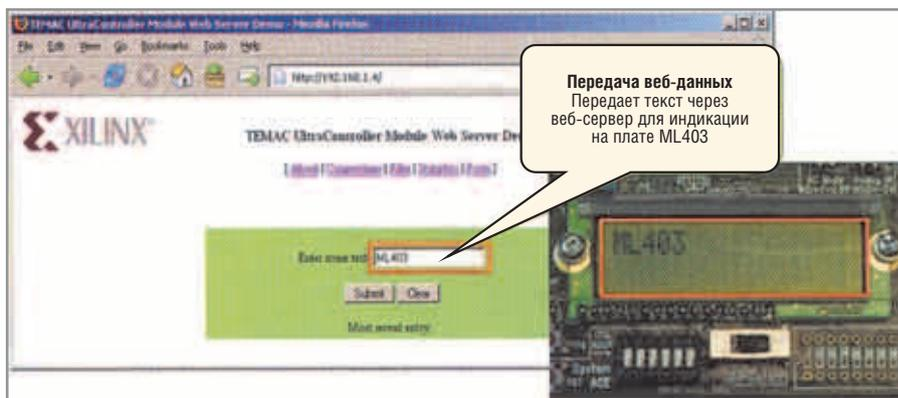
Рис. 2. Пример веб-сервера, обеспечивающего удалённое управление платой ML403
