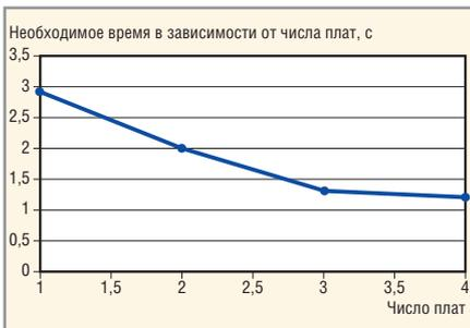
Рис. 6. Использование нескольких плат для уменьшения времени вычисления
