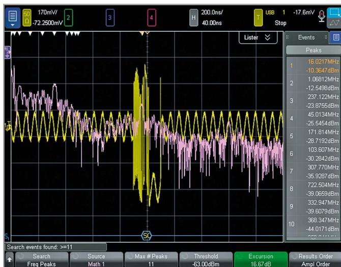
Рис. 8. Сигнал USB с шумом тактовой частоты 16 МГц
