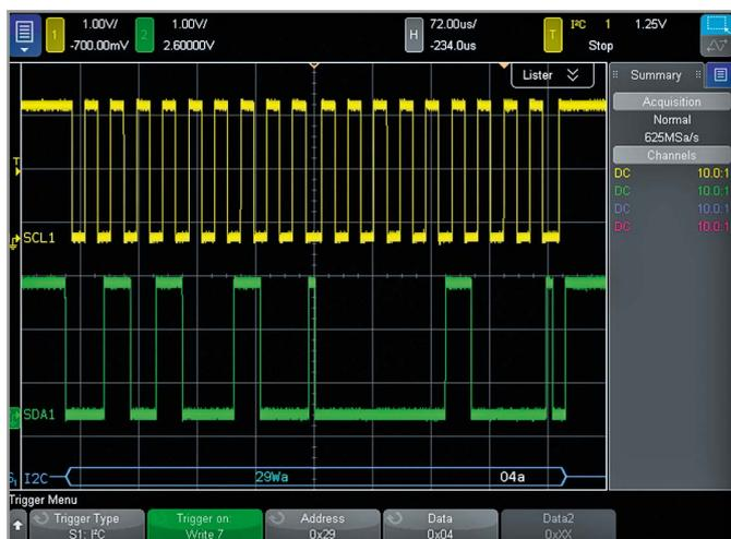
Рис. 2. Запуск по сигналам шины I<sup>2</sup>C и автоматическое декодирование данных
