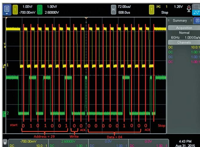
Рис. 1. Ручное декодирование данных шины I<sup>2</sup>C
