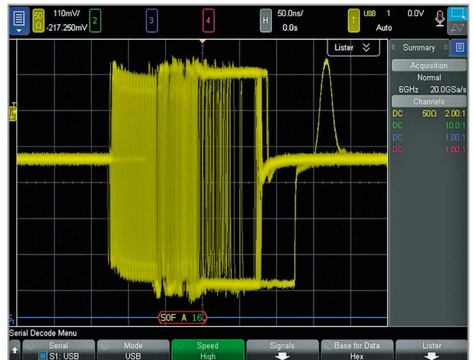
Рис. 4. Сигнал USB с наведённой помехой
