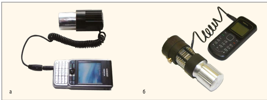
Рис. 4. Источник тока на базе МГВ и ВВТЗ: а – с 7 ТЭ, б – дополненный БНВ с DC/DC-преобразователем
