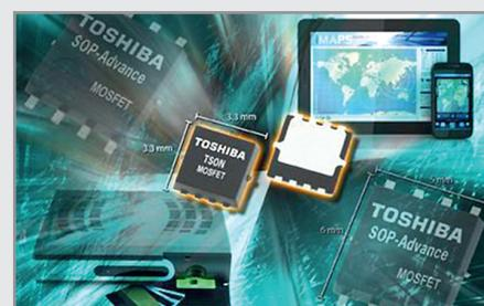
Элементы TPC806x-H и TPC822x-H поставляются в корпусе SOP-8 или в Dual-Chip-SOP-8, а варианты TPCC806x-H – в корпусе TSON-Advanced. Они допускают мощность рассеяния 1,9 Вт.
