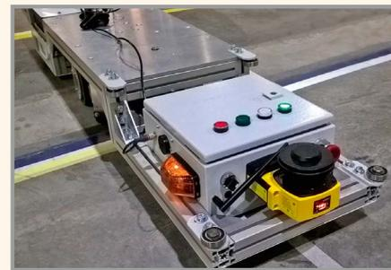
Блок управления AGV – это законченный программно-аппаратный модуль, включающий элементы контроля питания, скорости, выбора траектории, лазерный сканер как элемент системы безопасности.
