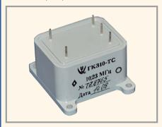
Эксплуатационные характеристики данного генератора позволяют использовать его в условиях открытого космоса в негерметичных отсеках космических аппаратов. Генератор обладает повышенной стойкостью к ВВФ, в том числе – специальным факторам.
