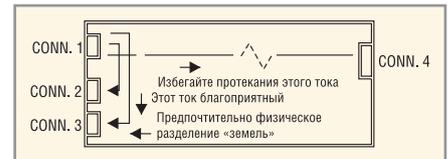
Рис. 11. Оптимальное размещение разъёмов на печатной плате
