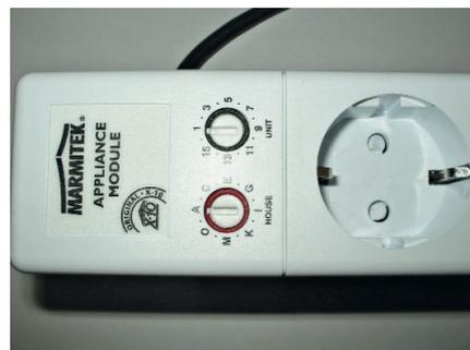
Рис. 4. Внешний вид модуля с интерфейсом X10
