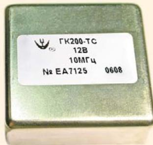
$\Delta f = 10$  Гц, –160 дБ/Гц для  $\Delta f = 10$  кГц) и сокращённым временем выхода на режим (до 3 мин). Отличные характеристики позволяют использовать ГК200-ТС для многих применений в области телекоммуникаций, а также в навигационной и измерительной технике. Возможны исполнения с напряжением питания 5 или 12 В и выходными сигналами SIN или HCMOS. В настоящее время выпускается серийно.
