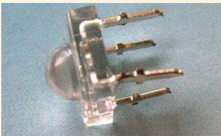
Данные светодиоды производства ОАО «Протон» имеют маркировку КИПД84, и на сегодняшний день предлагаются к поставке светодиоды красного и желтого цветов свечения. Конструкция светодиодов позволяет получить силу света не менее 2 кд для угла излучения 70° и не менее 4 кд для угла излучения 40° в диапазоне температур –60...+85°С. Гарантированный срок службы не менее 100 000 ч.
