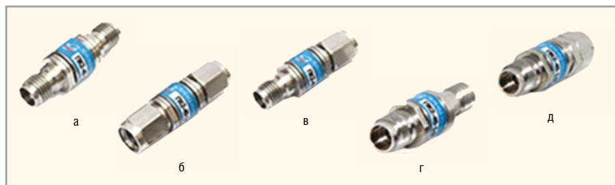
Рис. 14. Адаптеры 2,92 мм: а – одноканальные «розетка – розетка», б – «вилка – вилка», в – «розетка – вилка»; г – межканальные «розетка 2,92 мм – розетка 2,4 мм», д – «вилка 2,92 мм – розетка 2,4 мм»
