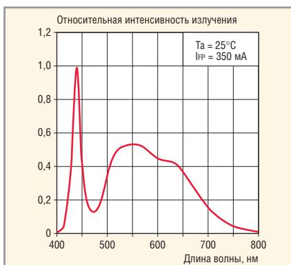
Рис. 12. Спектральная характеристика светодиодов NCSW119-H3
