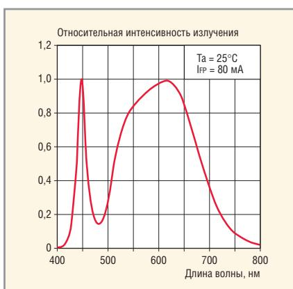
Рис. 14. Спектральная характеристика светодиодов NSSL157-H3
