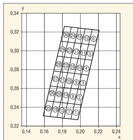
**Рис. 17. Расположение координат цветности светодиодов NHSB046-H3**
