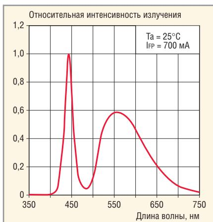
Рис. 8. Спектральная характеристика светодиодов NS6W183
