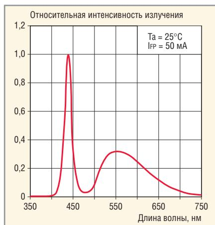
**Рис. 16. Спектральная характеристика светодиодов NSPWR70CS-K1**
