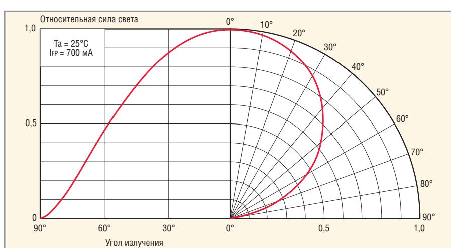
Рис. 9. Диаграмма углового распределения силы света светодиодов NS6W183
