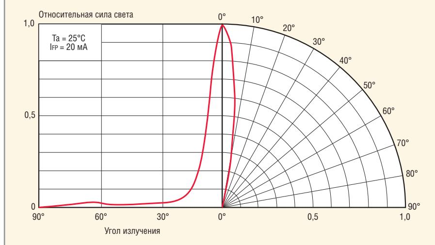
**Рис. 19. Диаграмма углового распределения силы света светодиодов NSPW500GS-K1**
