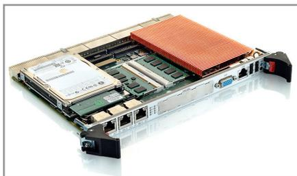
**Рис. 2. Плата Kontron CP6003-SA в формате Compact PCI высотой 6U, поддерживающая четырёхядерные процессоры семейства Sandy Bridge с тактовой частотой до 2,1 ГГц и O3V типа DDR3 объёмом до 16 Гб**
