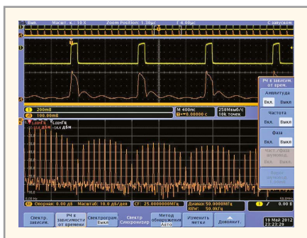
Рис. 10. Построение сигнала по данным ограниченного спектра
