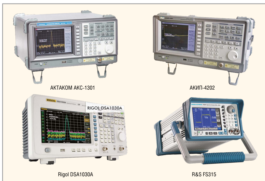
Рис. 7. Бюджетные цифровые анализаторы спектра со следящим генератором
