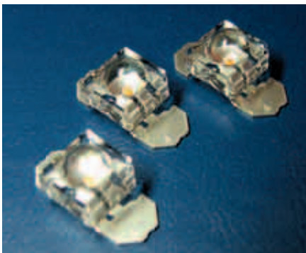
Рис. 2. Внешний вид светодиодов SnapLED
