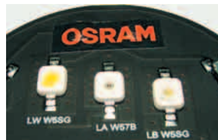
Рис. 7. Внешний вид мощных светодиодов компании Osram OS
