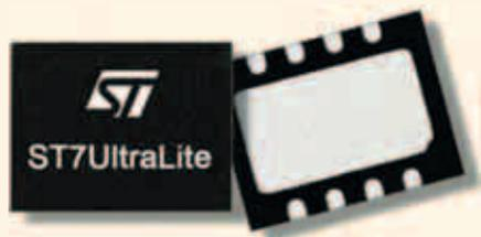
Корпус DIP16 позволяет проводить полноценную отладку без эмулятора. Версия в корпусе DFN – наименьший по размеру 8-выводный МК на рынке благодаря толщине корпуса 0,9 мм с общей занимаемой площадью всего 15,75 мм<sup>2</sup>.
