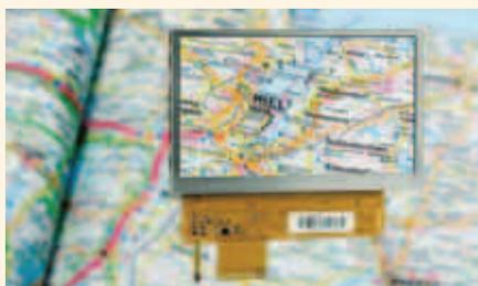
LQ043T3DX04 обеспечивает хорошую считываемость, бесперебойную работу в жёстких окружающих условиях в диапазоне температур -20...+60°C и яркость до 230 кд/м². Следующая модель планируется с сенсорным экраном.
