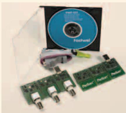
Всего доступно шесть вариантов модуля: исполнение с печатной антенной и разъёмом BNC для внешней антенны и три варианта последовательных интерфейсов: UART, RS-232 и USB. Из встроенной периферии модули оснащены четырёхканальным 12-битным АЦП, аппаратным ШИМ-контроллером и цифровыми выводами общего назначения. Питание модулей может
