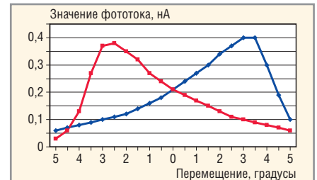
Рис. 3. Графические зависимости фототока от перемещения микровинта
