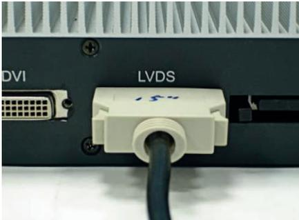
**Рис. 4. Соединитель LVDS на тыльной стороне корпуса встраиваемого компьютера REC5415**
