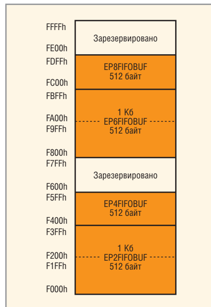
Рис. 2. Распределение адресного пространства FIFO
