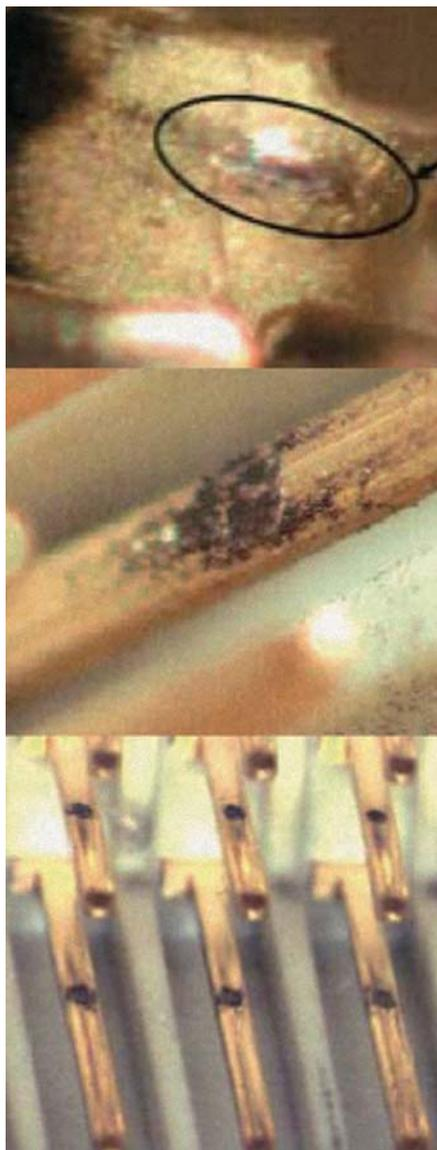
Рис. 1. Подгорание электрических контактов в стандартном соединителе ВКС
