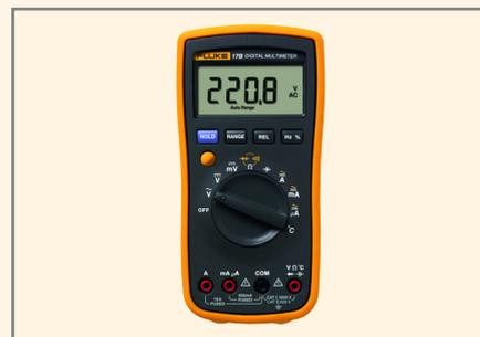
(0,1 мВ...1000 В), сопротивления (0,1 Ом...40 МОм), ёмкости (0,01 нФ...100 мкФ), измерения переменного и постоянного тока (0,1 мА...10 А);
