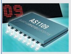
Последовательный интерфейс с частотой 30 МГц обеспечивает высокую частоту обновления изображения даже в самых больших дисплеях. При рабочем температурном диапазоне от –40 до +125°C AS1109 пригодна для промышленных и наружных приложений. Микросхема AS1109 выпускается в 16-выводных корпусах SOIC-150, SSOP-150 и QFN (4 × 4 мм).
