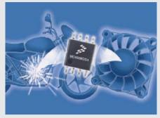
Центральный процессор МК HCS08 16 МГц, система команд HC08 с дополнительной командой BGND (Background), Flash-память 4 Кб, RAM 256 байт. Считывание, запись и стирание Flash-памяти производится во всём диапазоне напряжений и температур. На чипе МК расположены 4-канальный 10-разрядный АЦП и два 16-разрядных таймера.
