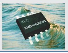
Максимальное сопротивление в открытом состоянии составляет 50 мОм, типичное – около 38 мОм (измерено при 4,5 A).
