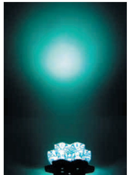
Рис. 8. Равномерность смешения цветов достигается уже в 10 см от линзы
