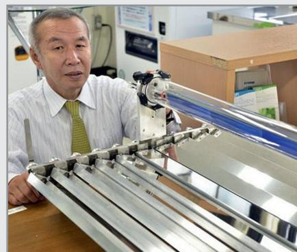
Новая солнечная панель защищена от перегрева механизмом перераспределения тепла, направляющим его излишки в водонагревательный контур. Таким образом, Smart Solar International смогла создать устройство «два в одном», обеспечивающее здание электричеством и горячей водой.
