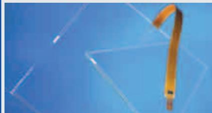
Касание экрана в любом месте вызывает необычный шум. Этот сигнал оцифровывается контроллером и сравнивается со списком прежде принятых образцов звуков. При совпадении курсор перемещается в место касания. Первый Touch-монитор с APR появится на рынке в сентябре 2006 г.
