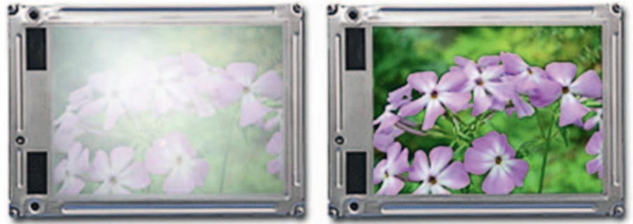
Рис. 2. Результат пассивного увеличения яркости задней подсветки
