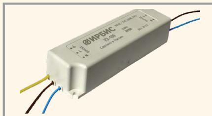
Устройство обеспечивает защиту потребителя от опасных факторов при пользовании сетями переменного тока (85...280 В). Выдерживает импульсы напряжения по 4-му классу жёсткости ГОСТ Р 51317.4.5-99. Обеспечивает защиту от микросекундных импульсов (разряд молнии) амплитудой до 10 кВ, а также от превышения нормальной величины сетевого напряжения (обрыв нулевого проводника), которая срабатывает при 430 В постоянного напряжения.
