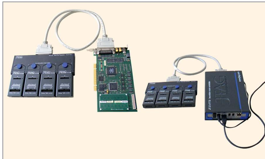
Рис. 2. Контроллер периферийного сканирования JT37x7 с 4 портами JTAG в исполнении USB/Ethernet и PCI
