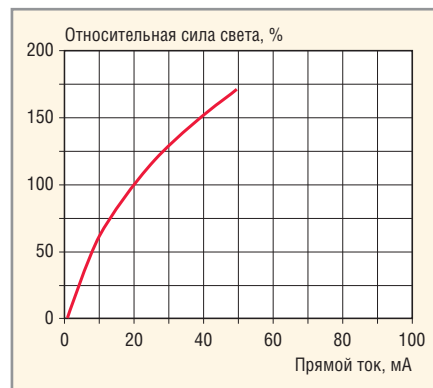
Рис. 2. Зависимость относительной силы света светодиодов от прямого тока
