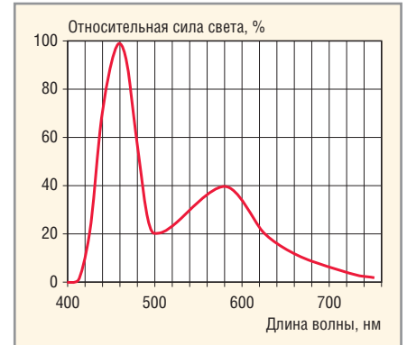
Рис. 8. Спектральная характеристика светодиодов BT5050WC-XX-P180
