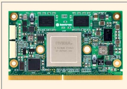
В качестве помощи разработчикам Kontron предлагает оценочную плату-носитель SMARC Evaluation Carrier Board и протестированную оценочную платформу, которая содержит «компьютер-на-модуле» SMARC-sAT30, плату-носитель SMARC Evaluation Board, предустановленную ОС Linux, дисплей 1280 × 768 с диагональю 10,6 дюйма.
