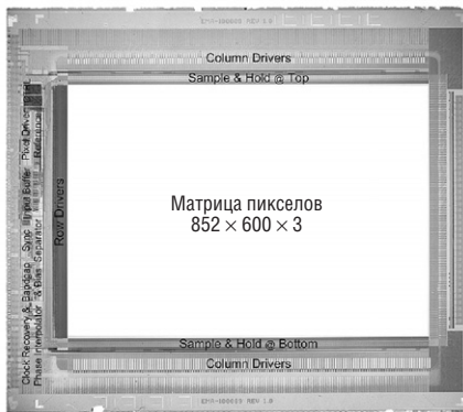
Рис. 7. Топология кремниевой подложки OLED-микродисплея
