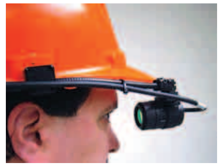
Рис. 17. Микродисплей eMagin в наглемной дисплейной системе
