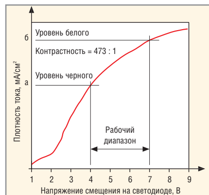
Рис. 4. Передаточная характеристика OLED-светодиода
