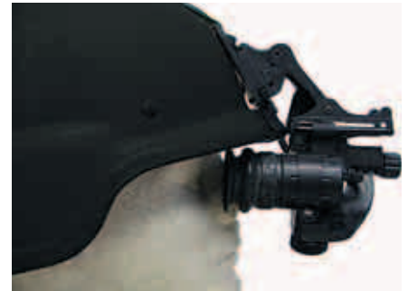
Рис. 18. Микродисплей LE-450 в системе ночного видения
