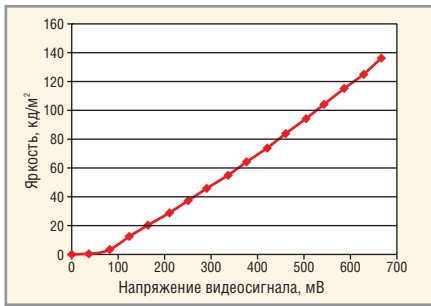
Рис. 5. Вольтъяркая характеристика микродисплея
